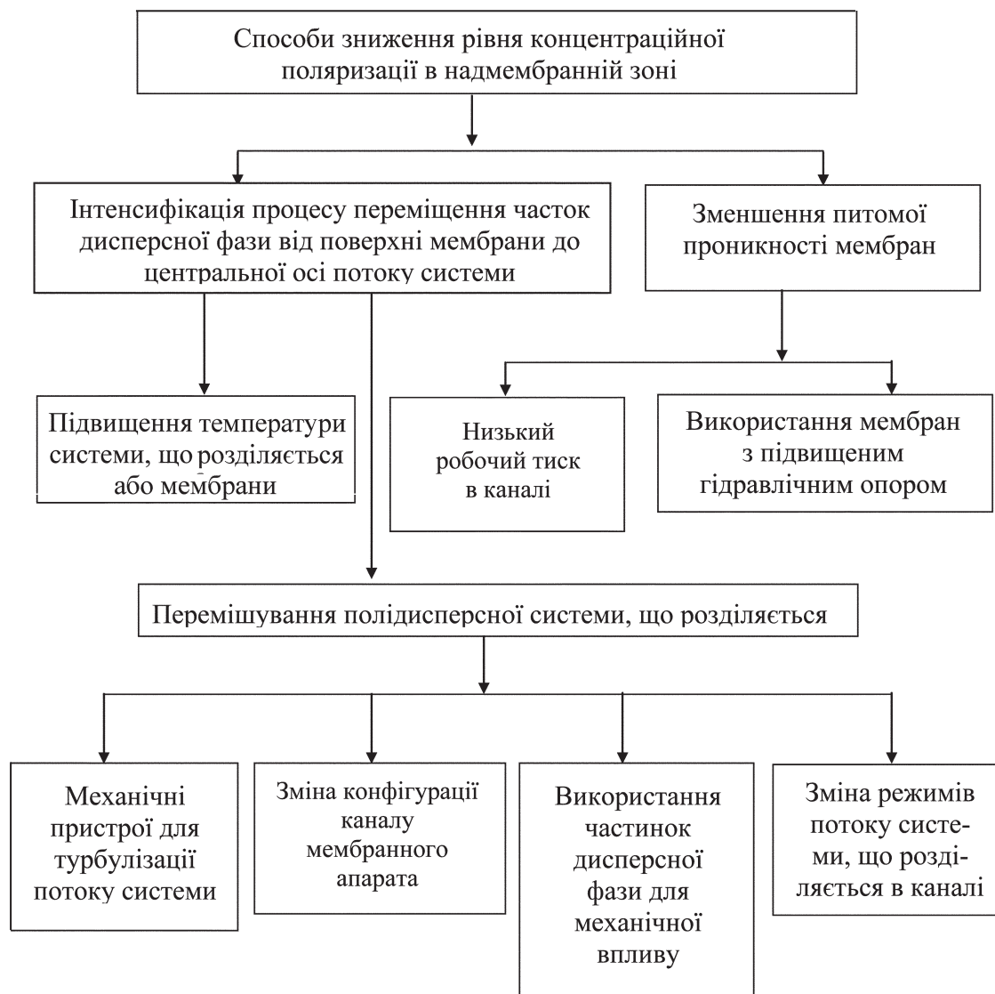
Рисунок 1 — Схема класифікації способів зниження концентраційної поляризації за баромембранного розділення РВПС (складено на основі [21])
