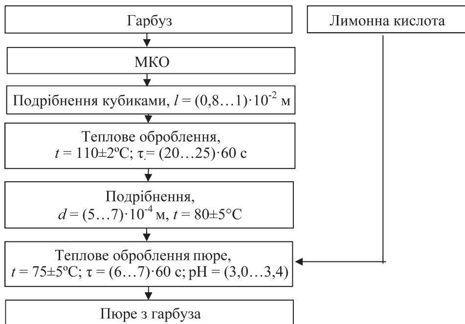
Рисунок 5 — Технологічна схема одержання пюре з гарбуза
